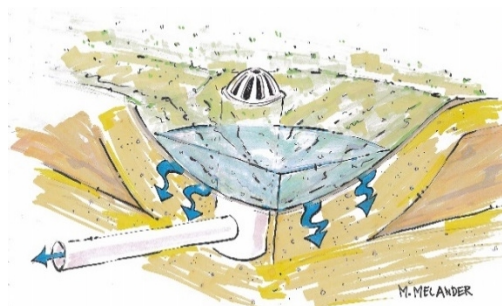
Figur 10. Skiss av ett perkolationsmagasin.
